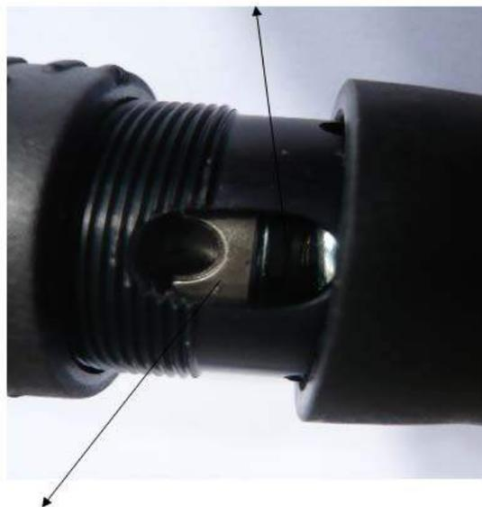
1 faire apparaître le trou de réglage du couple en faisant tourner l'embout, la douille ou le carré de l'outil
